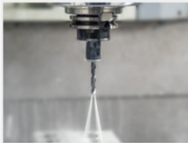
Koeling door het spindel
