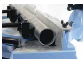
Bevestigingsset "K" voor buizen Ø 30 tot 70 mm
