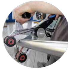
Perfect voor het afwerken van buizen, tot 270° contact met het werkstuk
