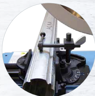
Ideaal voor het zagen van rolluikbuizen met het excentrische klemstelsel Ref. 609910
