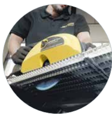
Ideaal voor het zagen van plaatwerk, roosters en sandwichpanelen tot 67 mm
