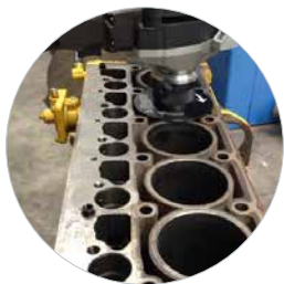
Ideaal voor het ontbramen en afkanten van rondingen en gaten afschuiven van laskanten op 30° en 45°
