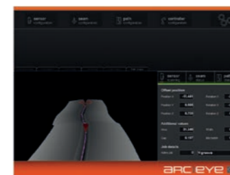
3D Seam-Tracking: Tijdens het lasnaadvolgen wordt de robot geleid door een 3D gescand landschap.
