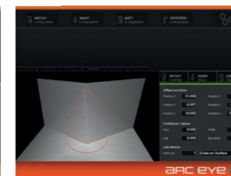
3D Seam-Finding: Het hoekpunt wordt in één zoekopdracht gezocht en gevonden.
