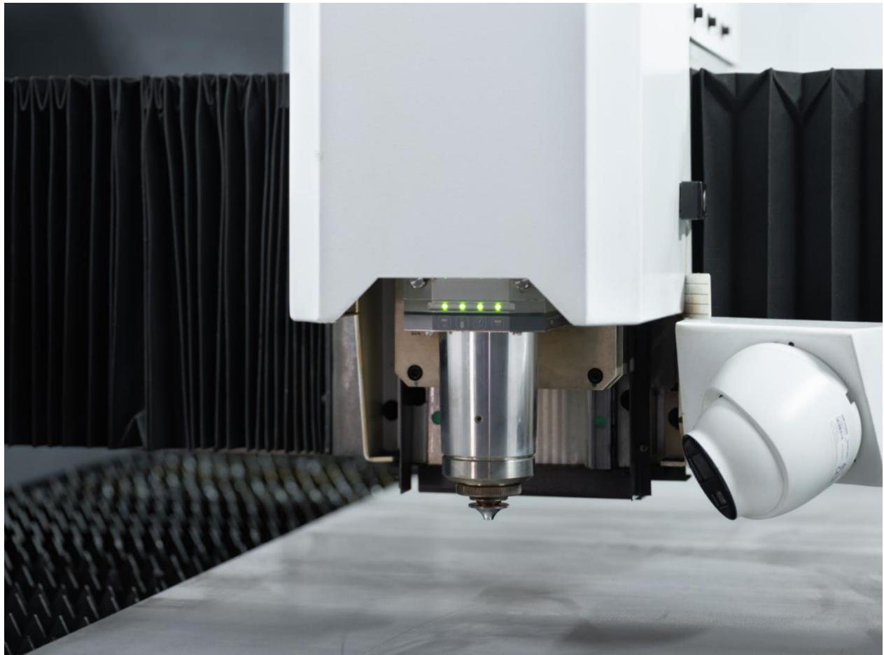
Afbeelding 3: Geteste componenten zoals de Precitec ProCutter 2.0 snijkop zorgen voor nauwkeurige en betrouwbare prestaties. © Messer Cutting Systems
