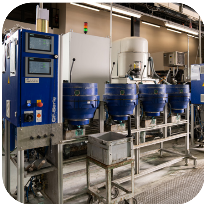
Ligne de tribofinition avec 9 machines
