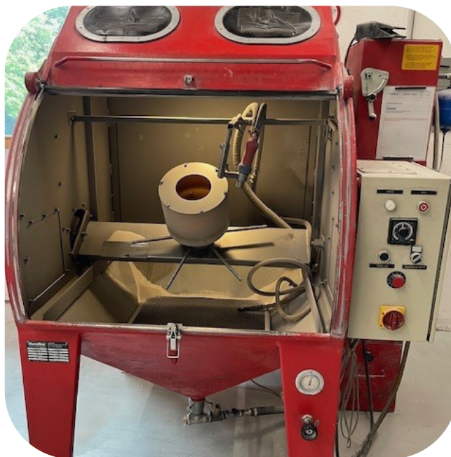
4 x Machines de micro-sablage
