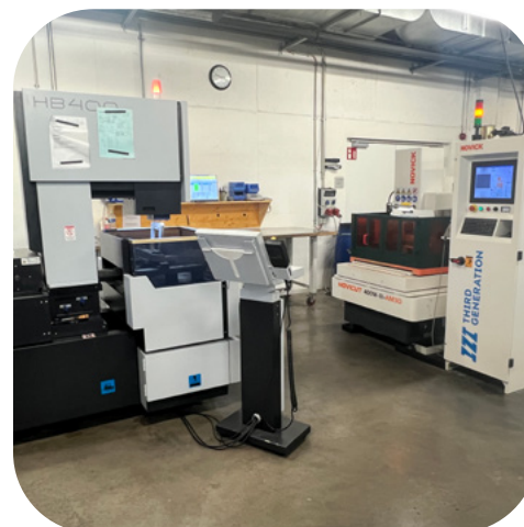
2 x Machines à fil molybdène
