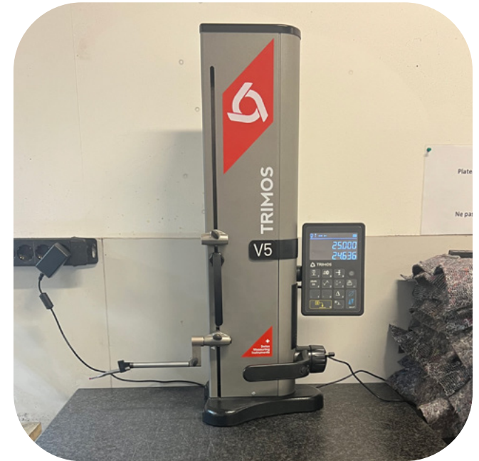
1 x Colonne de mesure Trimos
